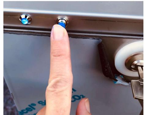
2. **Option Schlüssel** - bitte überprüfen Sie, ob die Schlüsselnummer auf den Schlüsseln gleich ist und mit der Nummer auf der ersten Seite der Bedienungsanleitung übereinstimmt. Stecken Sie den Schlüssel in das Schloss und drehen Sie den Schlüssel um 90° nach rechts. Achtung, der Schlüssel lässt sich in dieser Stellung nicht herausziehen, sondern nur wenn das Schloss zu ist. Öffnen Sie die Klappe durch das Ziehen am Griff (nicht am Schlüssel).
